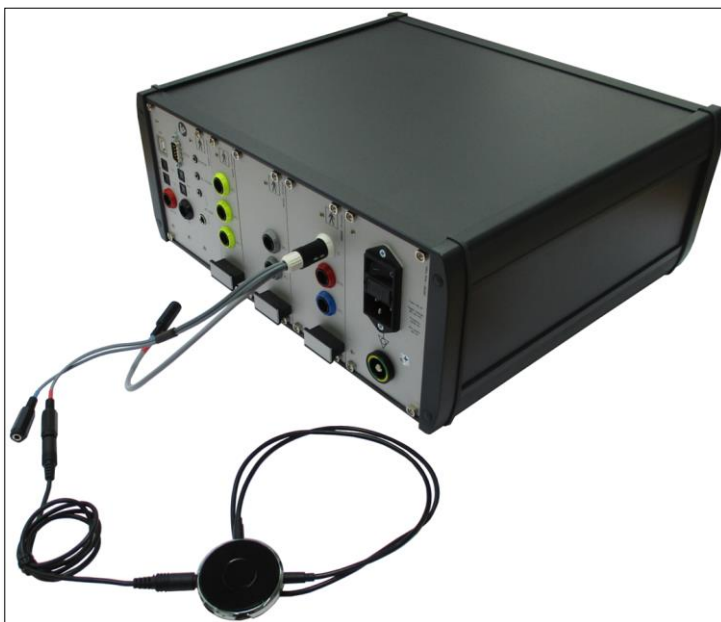
Illustration 290: Montage avec l'audiomètre et raccordement du câble au Streamer SAMBA 2 GO
