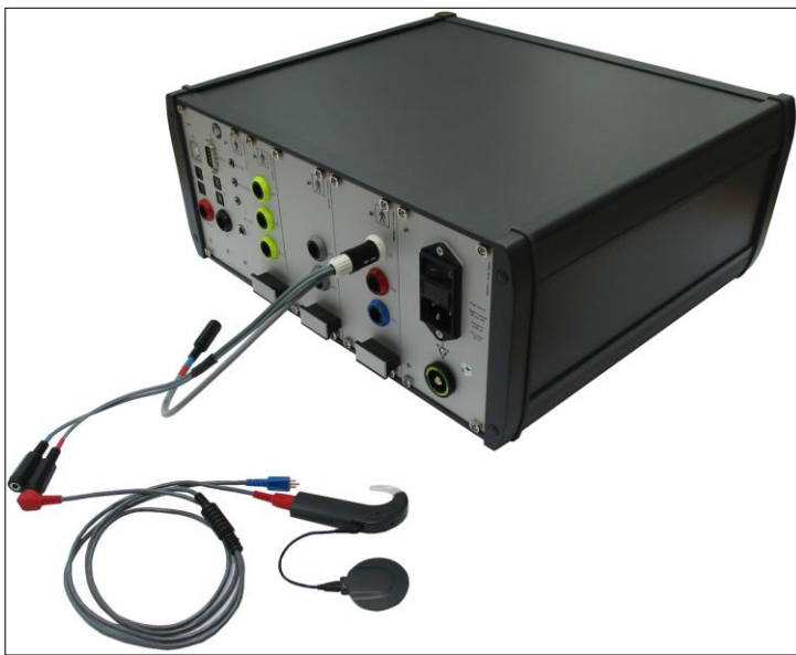
Illustration 289: Montage avec l'audiomètre et alimentation directe par câble dans le processeur CI SONNET
