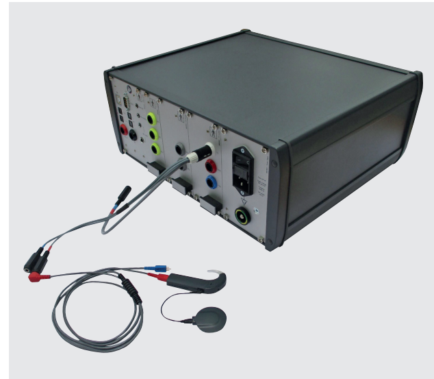
Grundmodul mit allen Anschlüssen, insbesondere mit der CI-Schnittstelle
