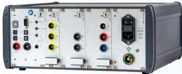
Die digitale Sounderzeugung hat die analoge abgelöst. Deshalb ist das Innere des Audiometers komplett neu konzipiert worden. Bei der Hardware des AT2000 haben wir auf die ausgereifte Technologie des AT1000 zurückgegriffen; die Software haben wir neu geschrieben.
